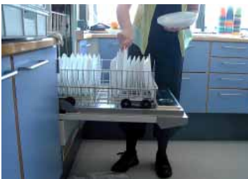
Opvaskemaskinen bør hæves fra gulvet. Det giver bedre arbejdsstillinger
