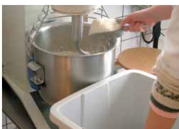
Røremaskiner skal være godt afskærmede. Bordmodeller kan placeres på et rullebord, så de kan flyttes væk, når de ikke bruges
